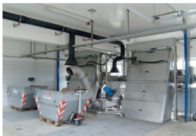
Две установки HUBER STEP SCREEN® SSV, длина 4300 мм, ширина 1676 мм, ширина прозора 6 мм, объединенная с моечным прессом HUBER WAP® типоразмера SL для интенсивной промывки. Полностью закрытая конструкция, не пропускающая запах.
