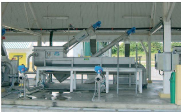
Установка ROTAMAT® с неаэрируемой песколовкой и интегрированным шнековым классификатором
