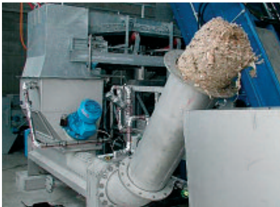
Residuo de desbaste lavado y compactado con una sequedad superior al 50 % MS
