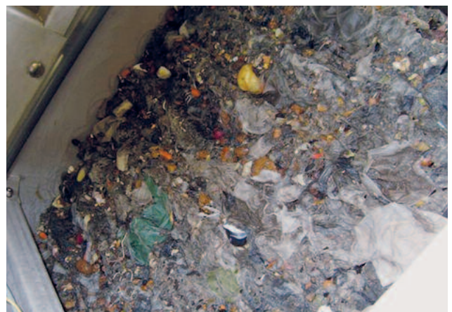
El tamiz STEP SCREEN® Flexible SSF tiene muy alta capacidad de separación debido a al diseño de las láminas móviles y a la formación de manto de residuos sobre ellas.
