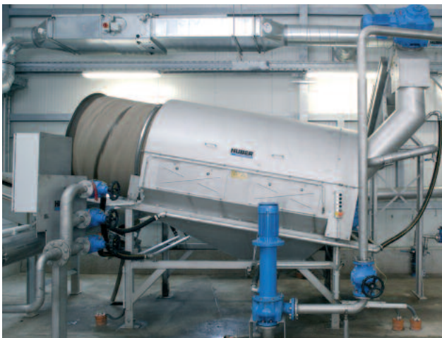
Tromel de lavado ROTAMAT® para el lavado y separación del material grueso mayor de 10 mm.
