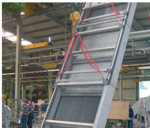
Prueba de funcionamiento en fábrica de una reja de gruesos HBUER RakeMax®.
