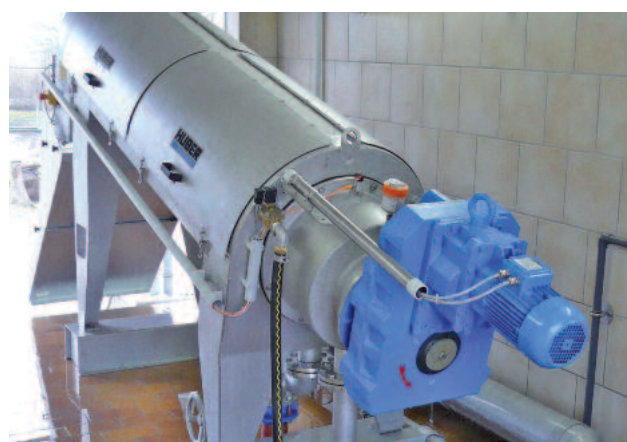
Prensa de parafuso para operações 24/7 sem necessidade de supervisão
