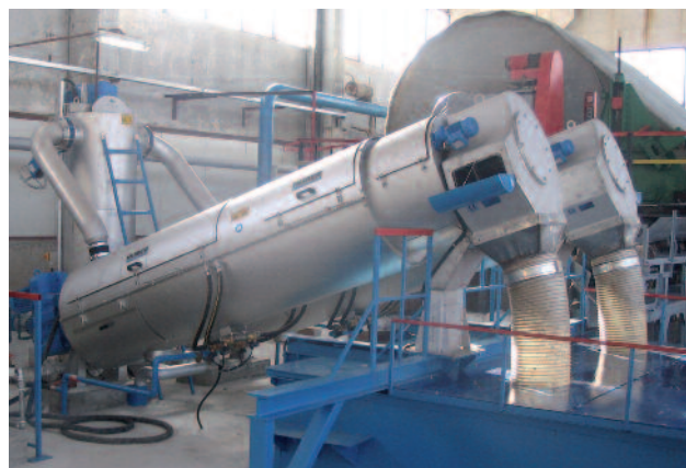
1 x 2 ROTAMAT® Schneckenpressen RoS 3 in paralleler Anordnung (Bulgarien)
