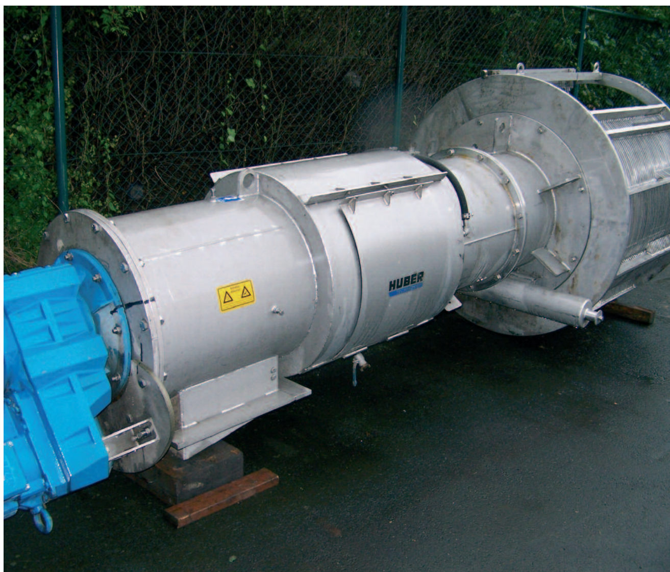
HUBER ROTAMAT® Rechenanlage Ro 1 Bio / 1600 / 15 mm mit Doppelräumarm und Austragsrohr (D = 711 mm)
