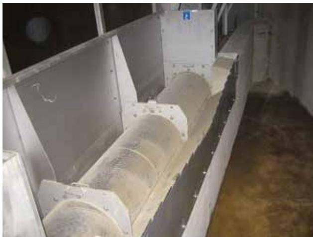
*HUBER Siebanlage ROTAMAT® RoK2 mit einer integrierten Messwehr zur Entlastungsmengenmessung.*
