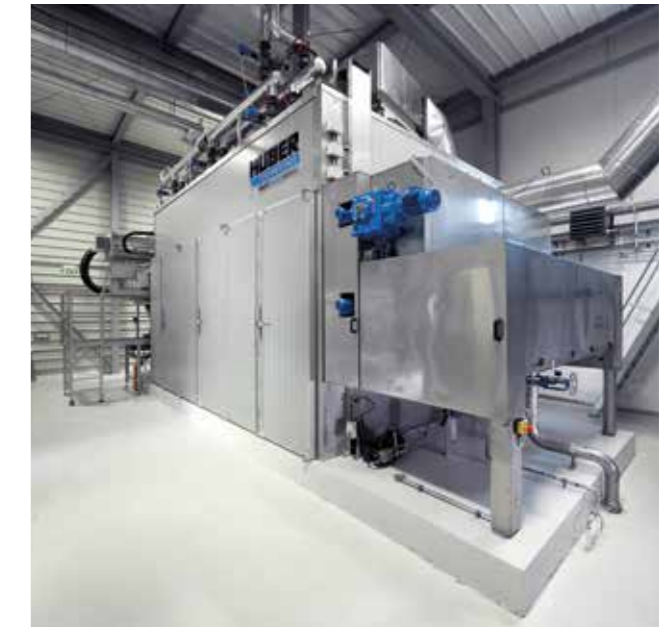
Kopfstück mit integrierter, automatischer Bandreinigung.
