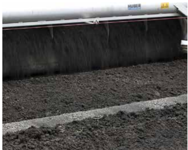
Der HUBER Schlammwender SOLSTICE® sorgt für ein optimales Trocknungsbeet – der Schlamm wird ausgebreitet, granuliert, belüftet, gewendet und rückgemischt.
