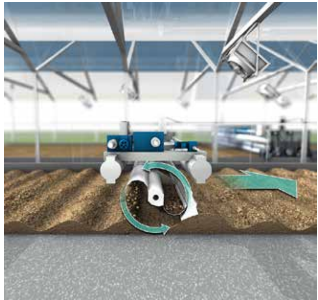
Die Doppelschaufel legt den Schlamm um, während die Maschine durch die Halle fährt.
