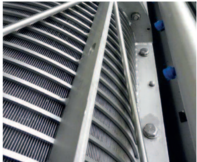
Robuster Spaltsiebkorb aus Edelstahl
