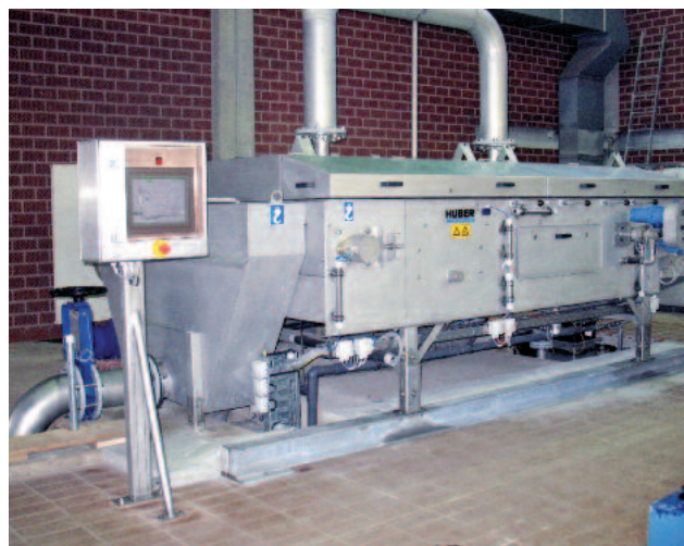
HUBER Bandeindicker DrainBelt für bis zu 100 m 3 /h Dünnschlamm
