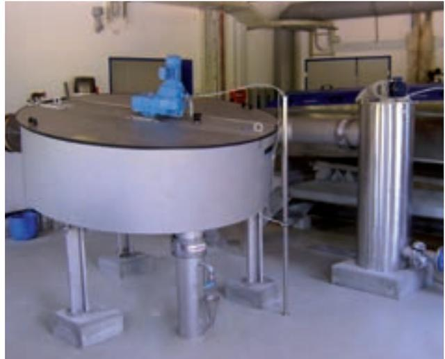
*HUBER Scheibeneindicker S-DISC Baugröße 2 mit vorgeschaltetem Flockungsreaktor.*
