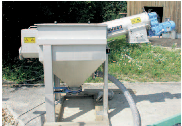
Die HUBER Mini Kompaktanlage MiniCop – für kleine Abwassermengen ideal
