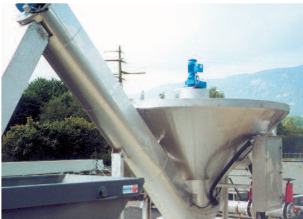
Innovative Technik: HUBER Coanda Sandwaschanlage RoSF4 3, beheizte Ausführung für den Betrieb im Freien.
