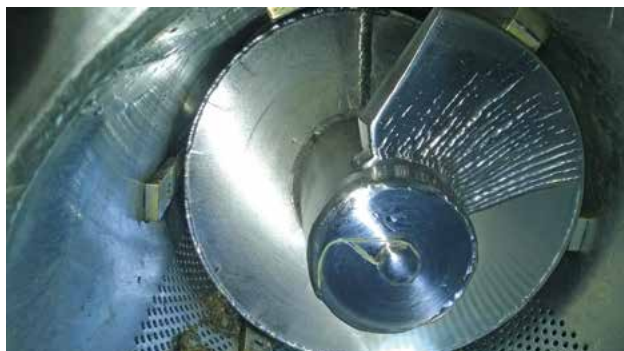
Beginnender Verschleiß an der Schneckenwelle.
