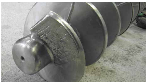
Fortgeschrittener Verschleiß an der Schneckenwelle.
