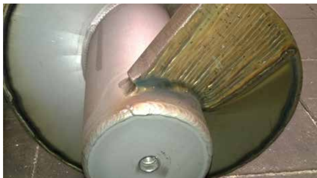
Neuwertiger Zustand der Schneckenwelle.
