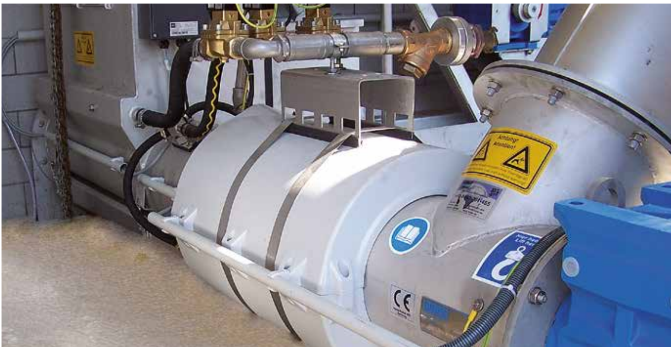
Kompakte Bauweise des HUBER Rechengutverdichter Ro7 – auch mit Rechengutauswaschung.
