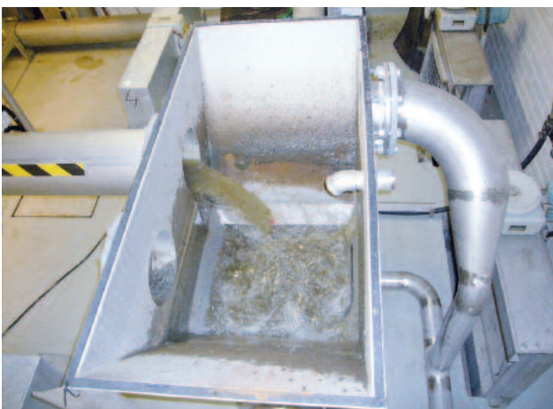
Transportwasser dient gleichzeitig als Waschwasser
