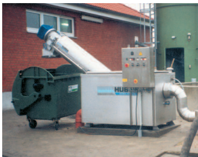
HUBER Fäkalannahmestation ROTAMAT® Ro3.1 mit HUBER Feinstrechen ROTAMAT® Ro1 in beheizter und isolierter Ausführung
