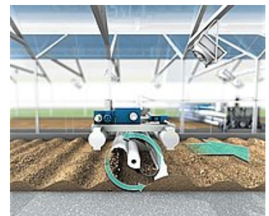
Die Doppelschaufel legt den Schlamm um, während die Maschine durch die Halle fährt
