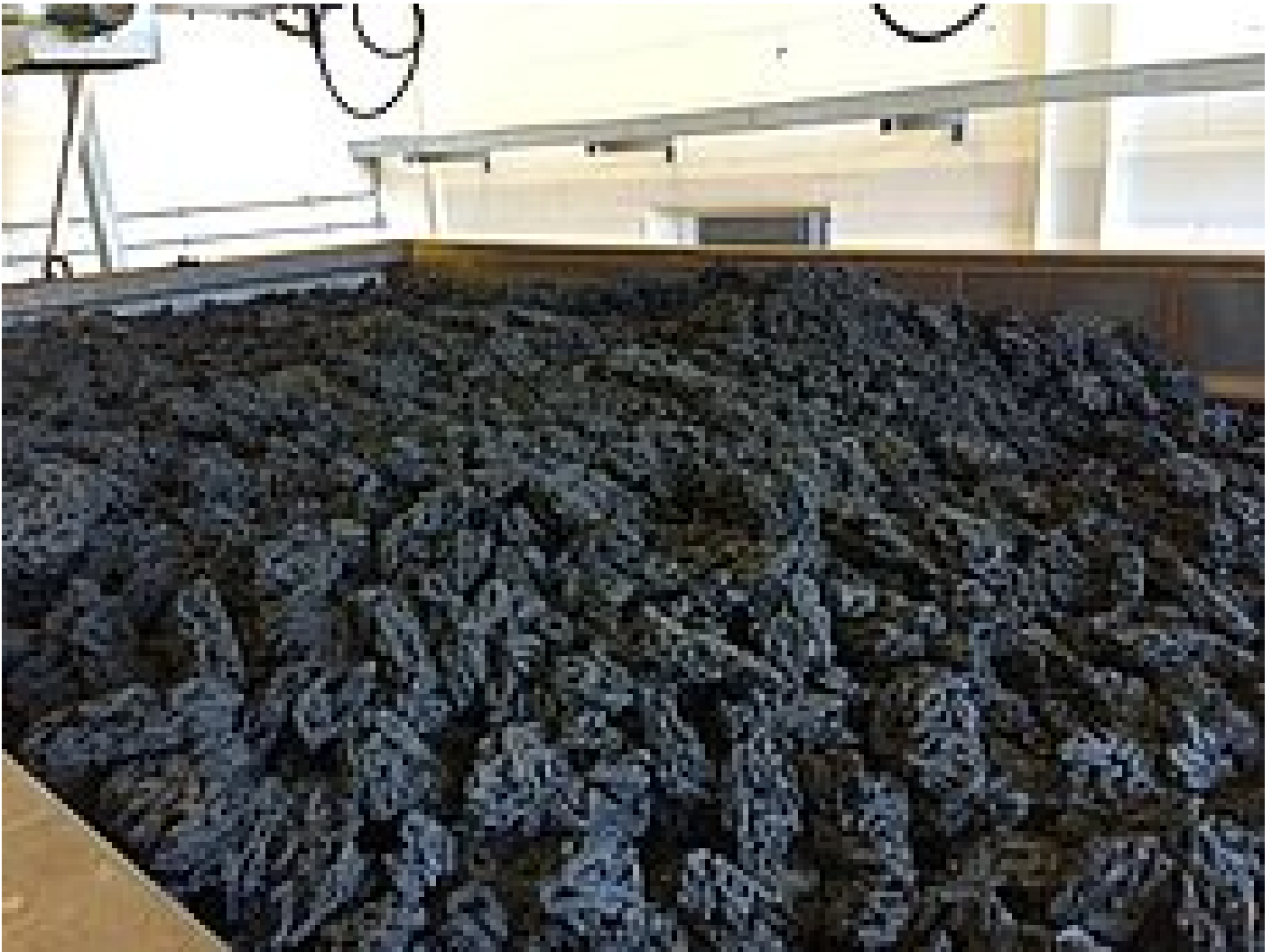
Getrockneter Klärschlamm im Transportcontainer
