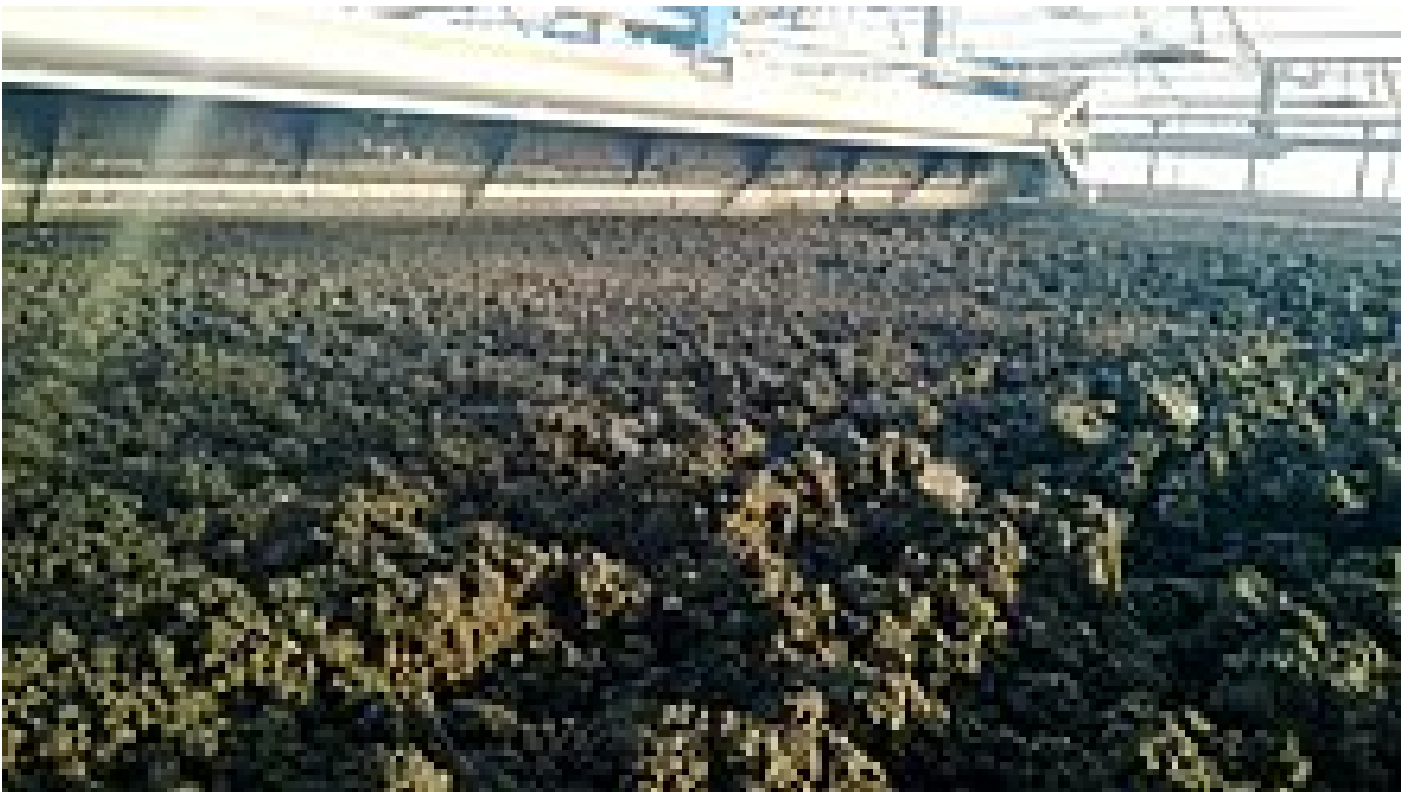
Schlammwenden trotz pastösem Verhalten: Die Maschinenteknik von HUBER ist robust und leistungsfähig
