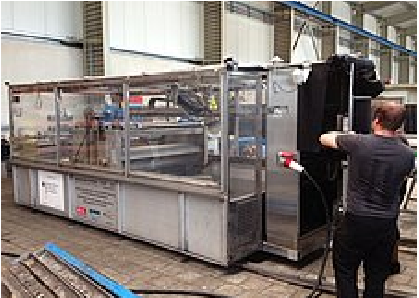
Zurückgekehrter Baby-Solartrockner bei der Überprüfung der Steuerung in der HUBER Service-Halle
