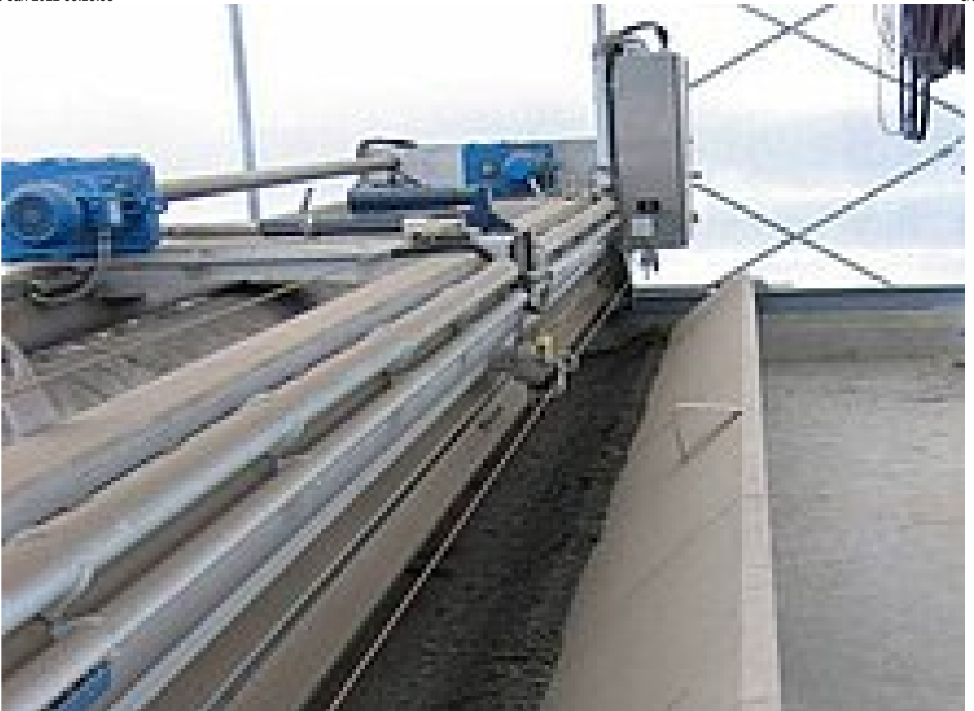
An der „Halfpipe“ wird der trockene Schlamm vom Wender aufgenommen
