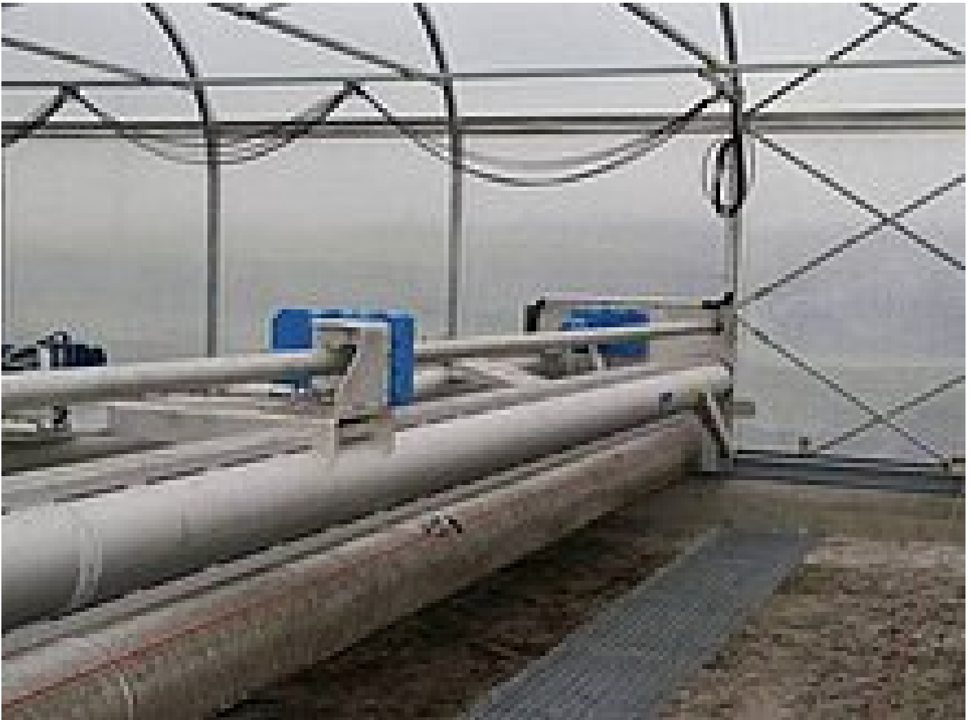
Der Wender kann auf seiner Rückfahrt den trockenen Schlamm in eine Schnecke ablegen, die im Boden versenkt ist.
