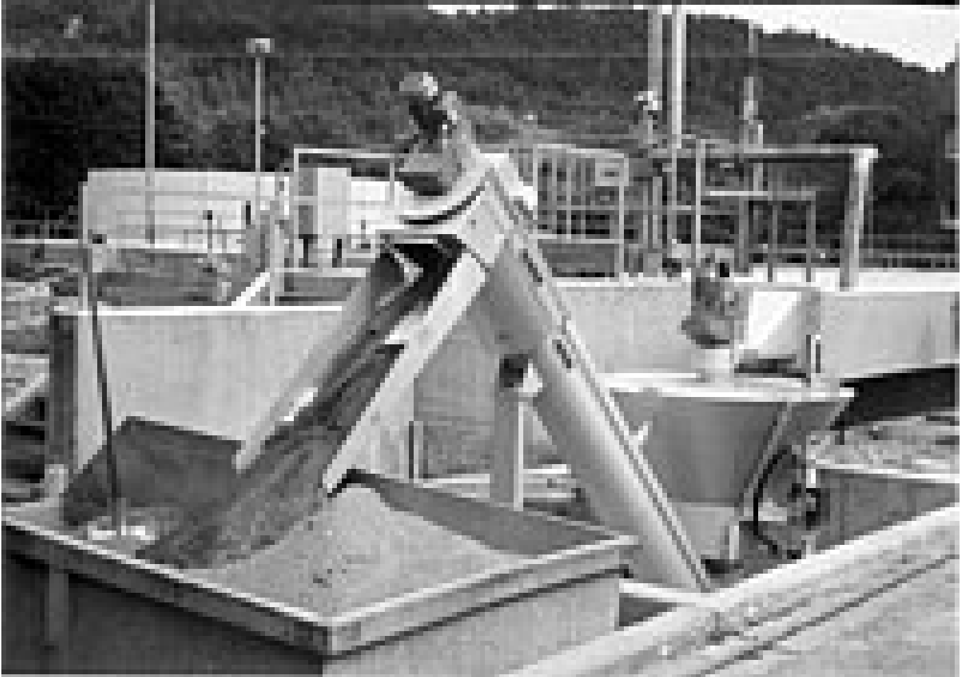
Neues Design der Coanda-Sandwaschanlage, Typ: RoSF4 / BG I auf der Kläranlage Beilngries/ Obb., Glühverlust < 1 %
