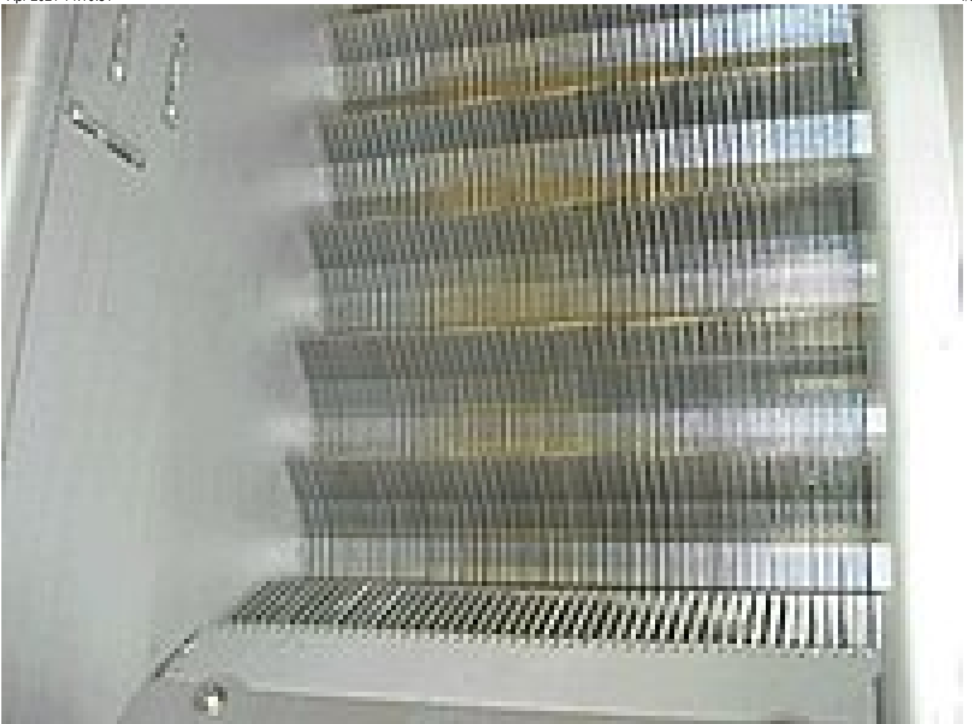
Die Sohlstufe des Stufen-rechens STEP SCREEN® Vertikal SSV.
