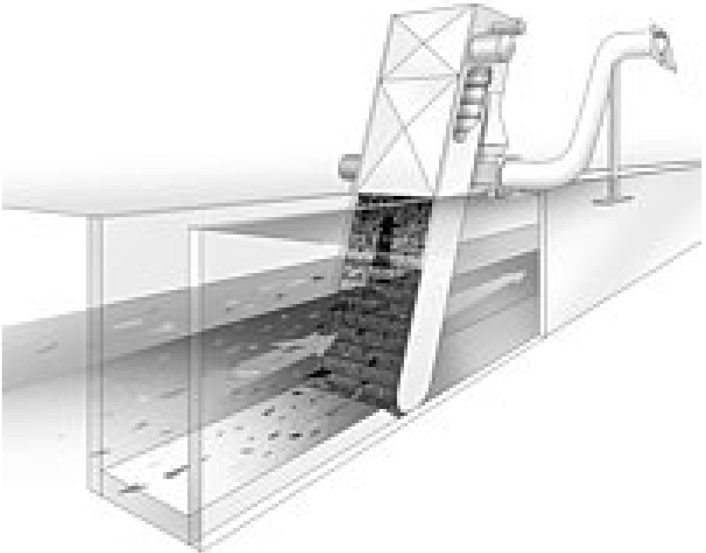
Der Umlaufrechen EscaMax® ist einsetzbar für Gerinnebreiten bis 2,2 m, Abwurfhöhen bis 6 m, Lochblechdurchmesser 3 und 6 mm (2 mm auf Anfrage)
