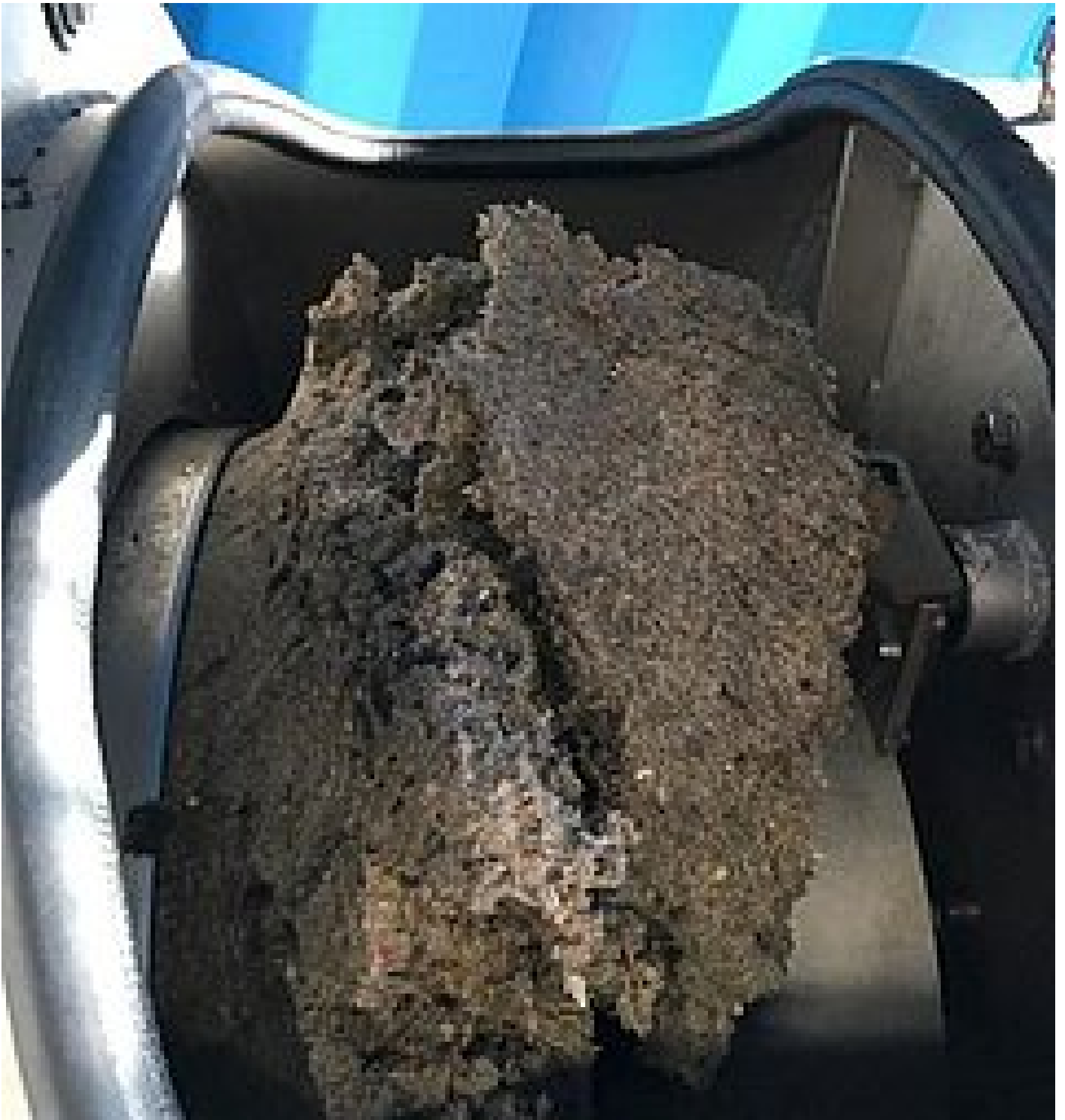
Bild 5: Maschinell entwässerter Dünnschlamm der Vorführanlage HUBER Trommelsieb LIQUID in einer HUBER Schneckenpresse Q-PRESS®
