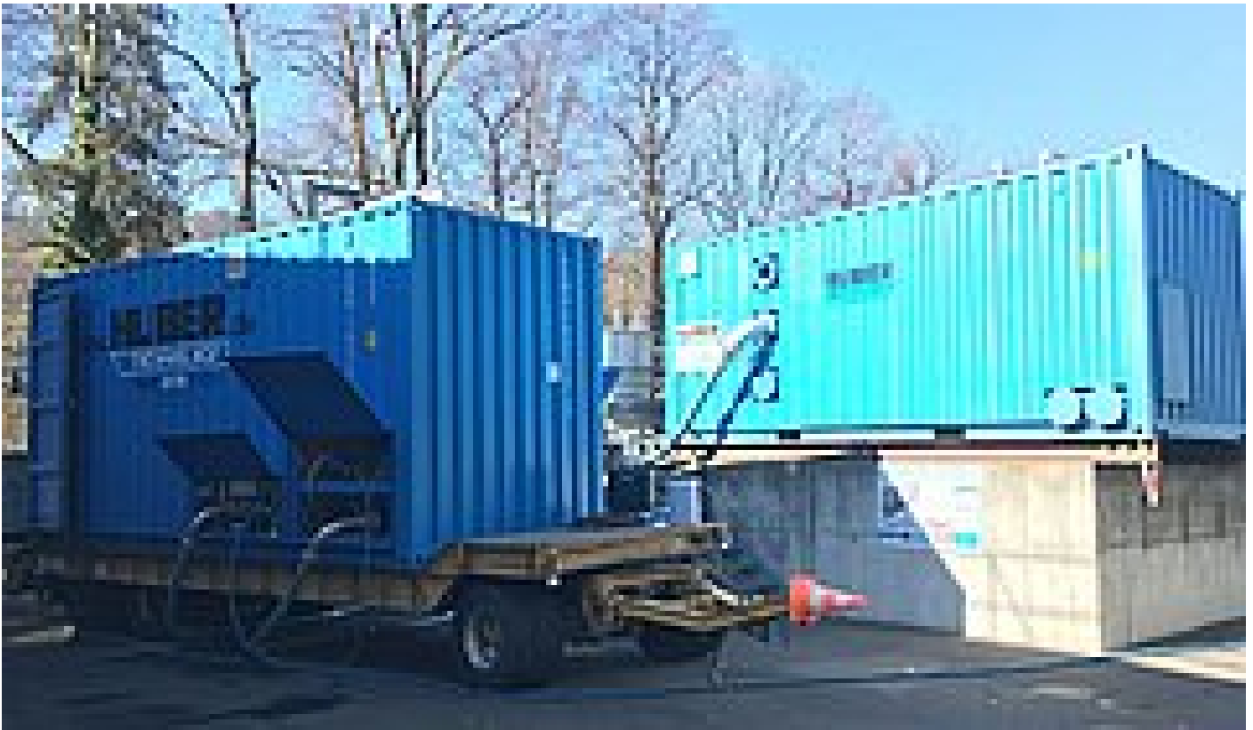
Bild 4: Validierungsbetrieb - Vorführanlage HUBER Trommelsieb LIQUID (rechter Container) kombiniert mit der Vorführanlage HUBER Schneckenpresse Q-PRESS® (linker Container)
