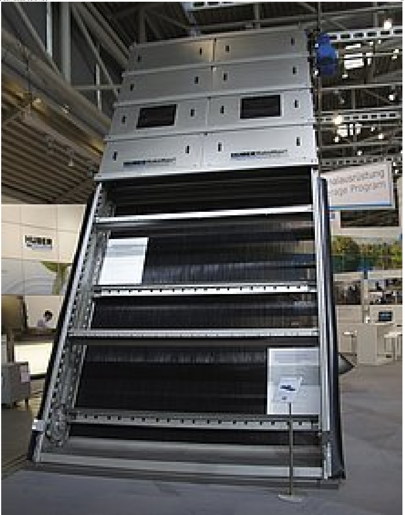
Ausstellungsstück auf der IFAT 2016: Ein 3,2 m breiter HUBER Haken-Umlaufrechen RakeMax® Hybrid
