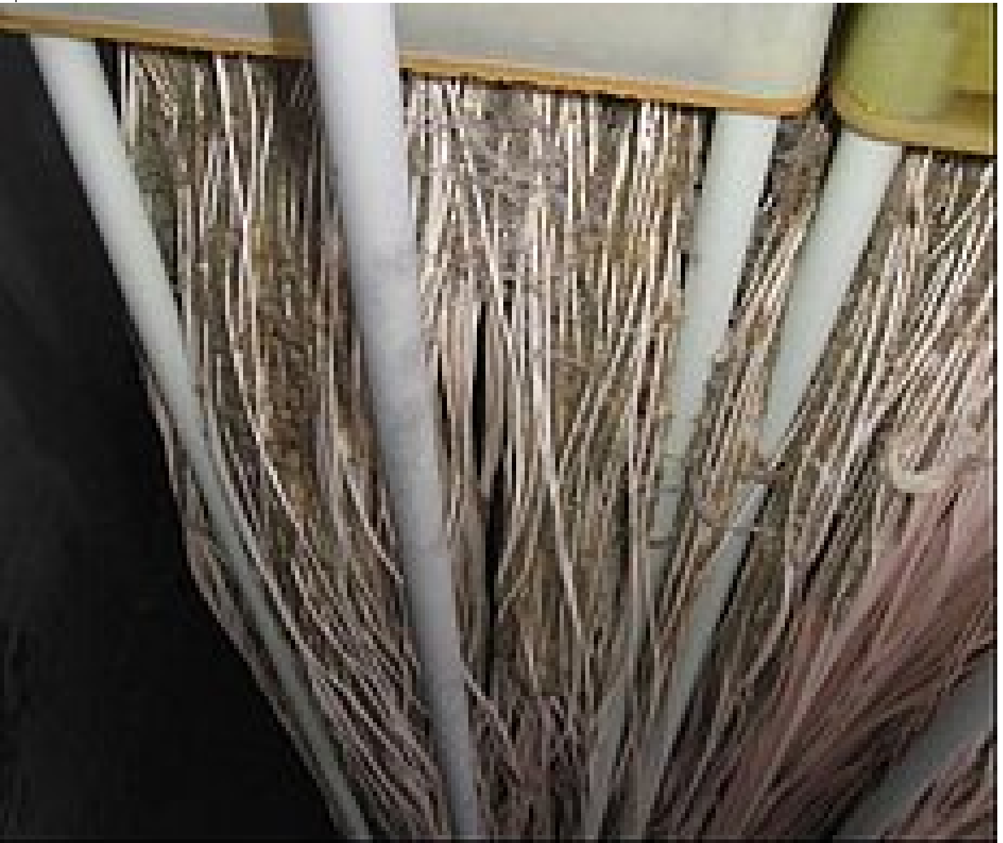
Verzopfte Holfasermembran durch unzureichende Vorreinigung des Abwassers
