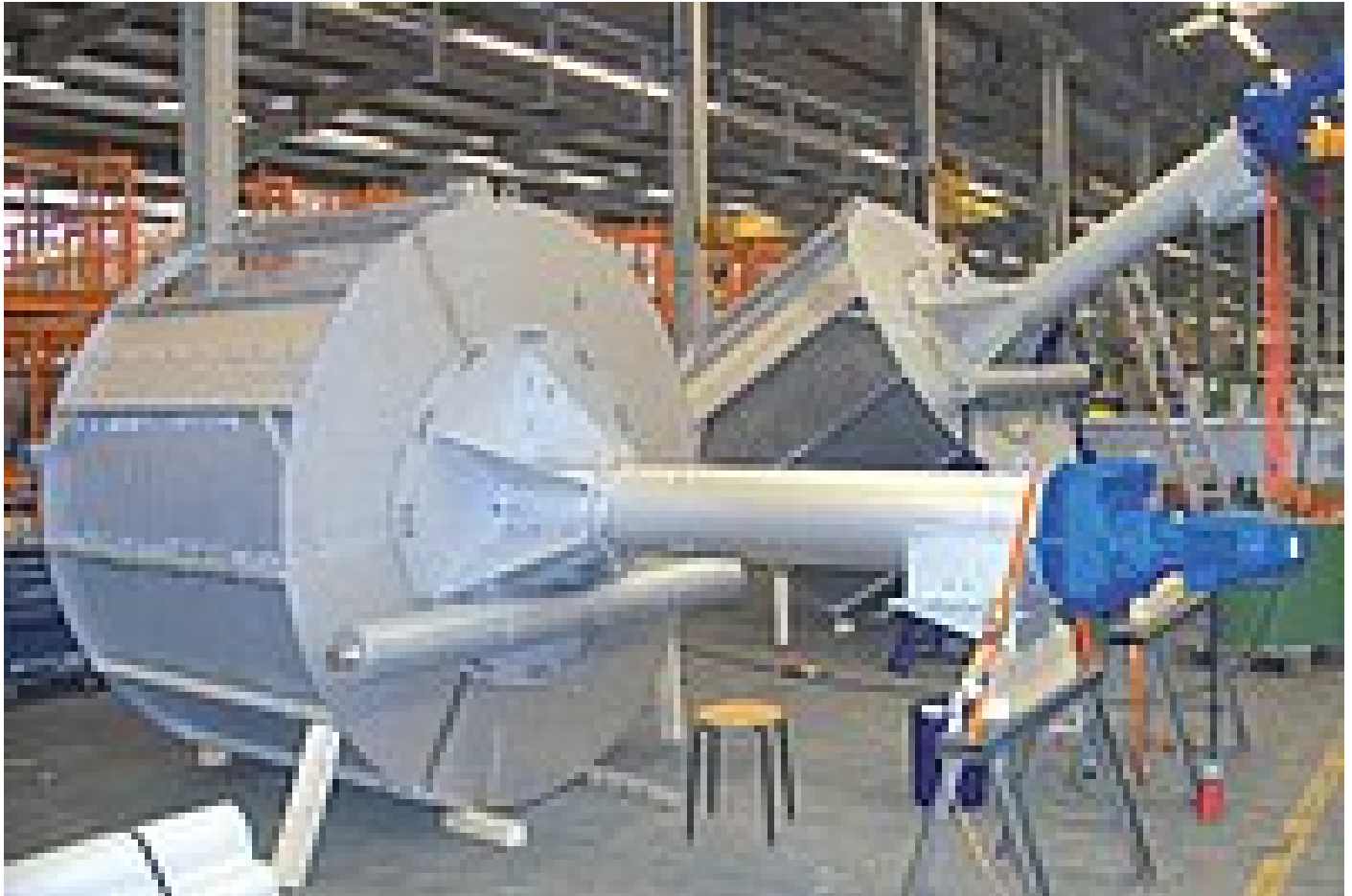
Zwei von insgesamt zwölf ROTAMAT® Feinstrechen Ro 1 / 2600 für die zweite Bauphase der KA Zhuyan.
