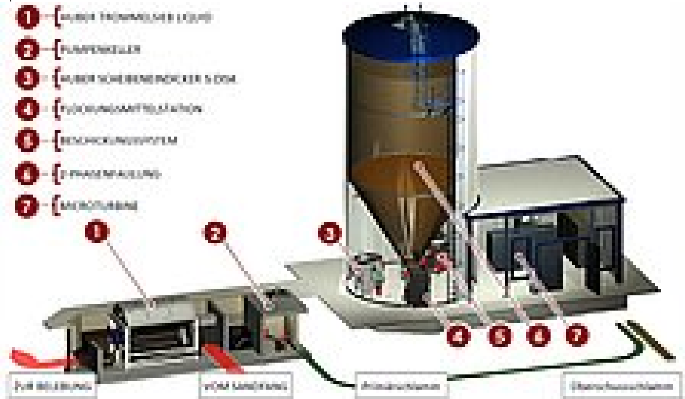
Abbildung 2: HUBER Trommelsieb LIQUID mit maximalen Reduktionsleistungen für abfiltrierbare Stoffe und CSB
