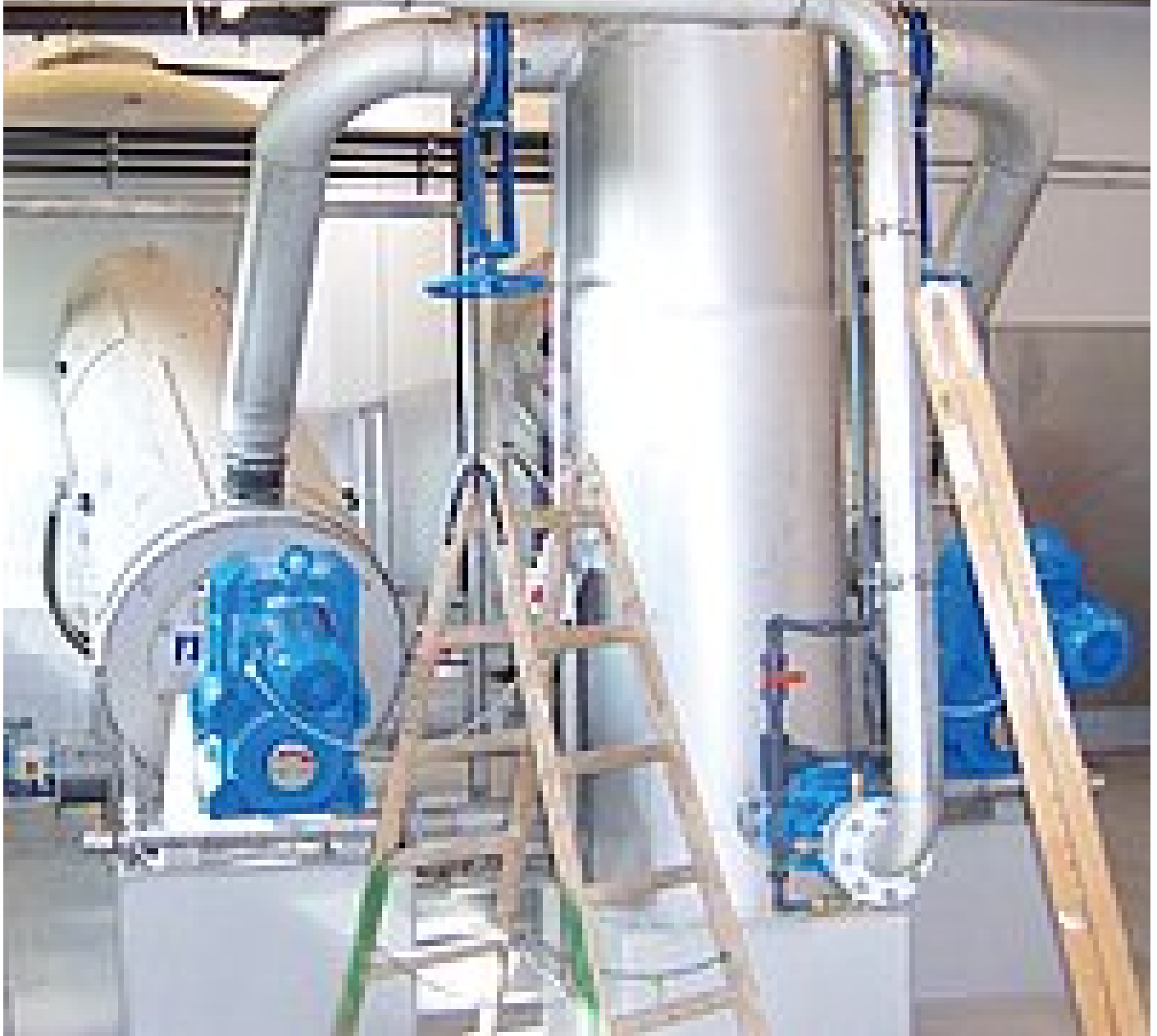
ROTAMAT® Flotatschlammwässerung RoS3/3 mit Flockungsrohrreaktor
