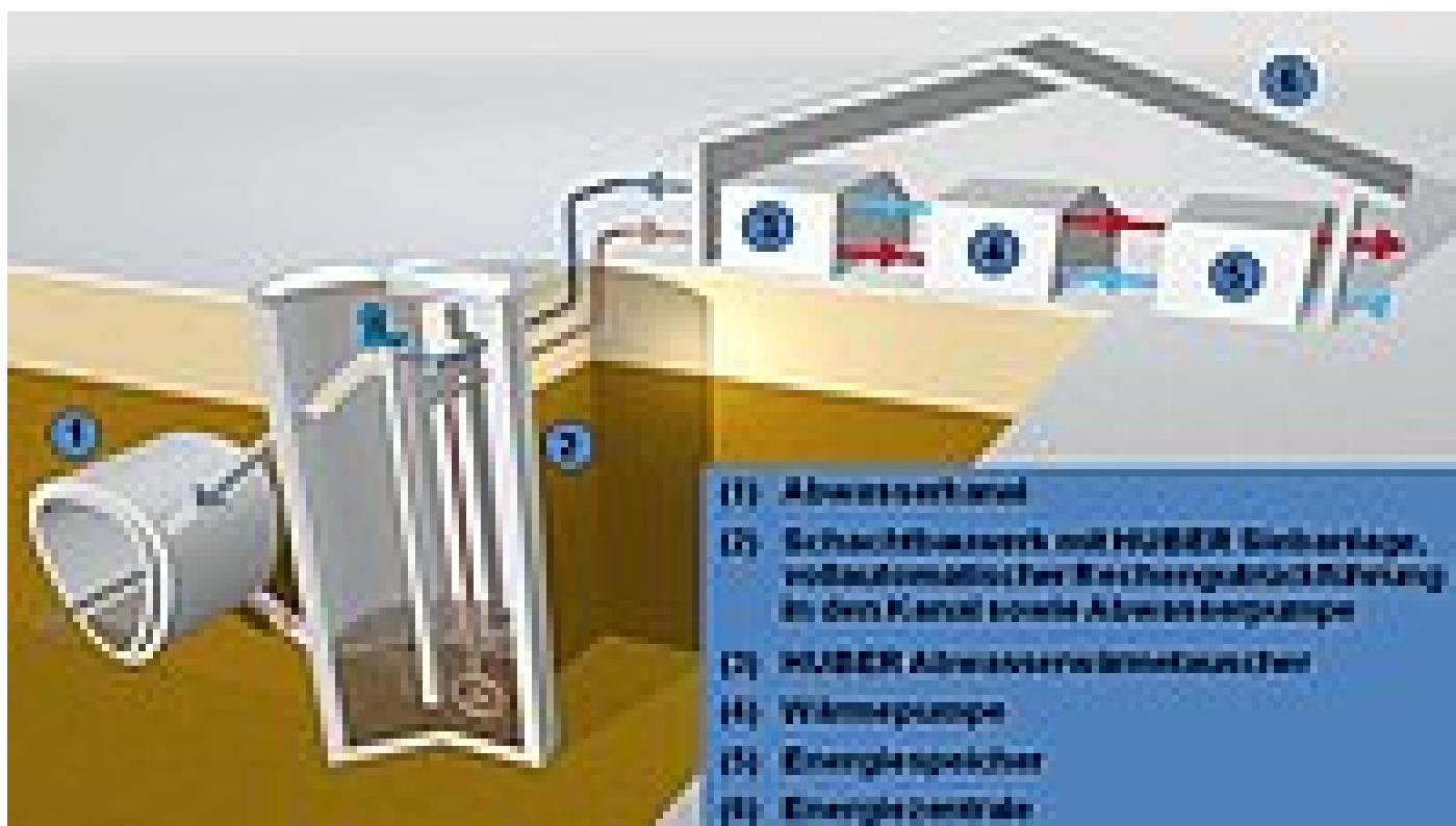
Prinzip des HUBER ThermWin®-Systems
