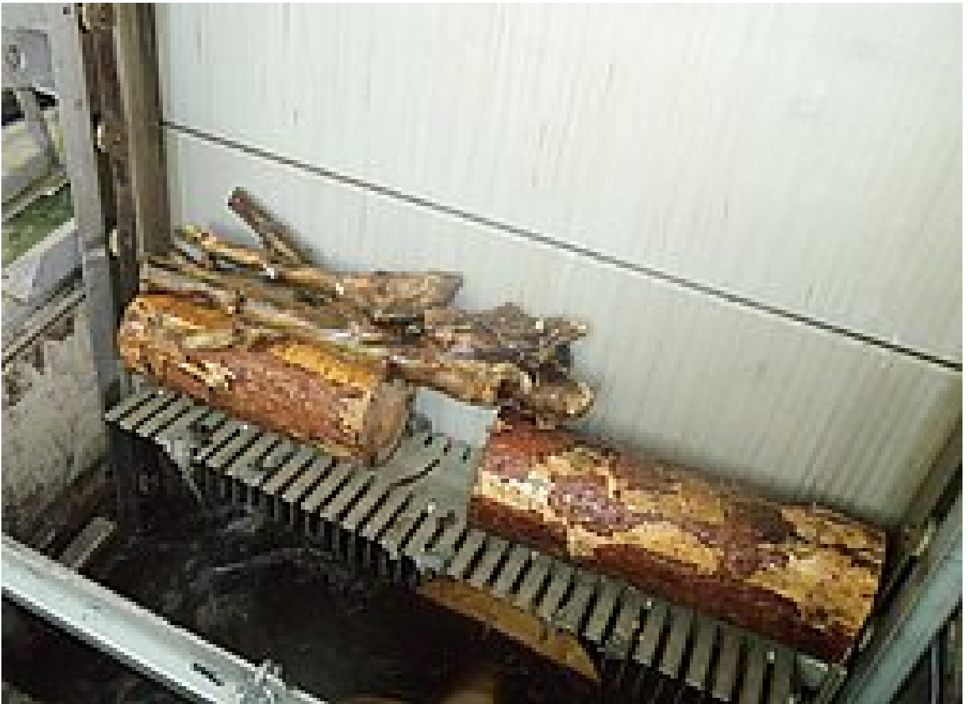
Sperrige Grobstoffe werden mit dem TrashMax® sicher erfasst und ausgetragen
