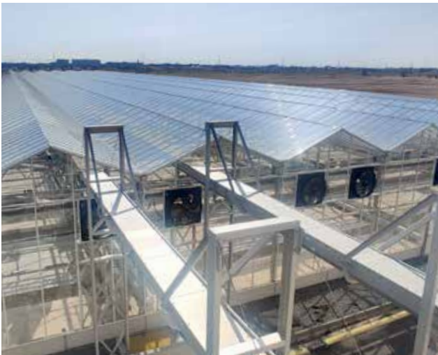
HUBER Trogförderschnecke Ro8 T als zuführende Förderbrücke auf eine solare HUBER Schlamm-trocknung.
