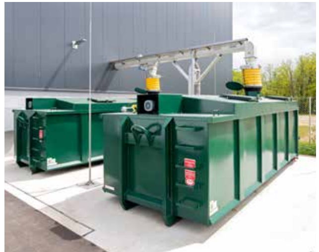
Die HUBER Trogförderschnecke Ro8 T für eine vollgeschlossene Entsorgungslösung mit Verladebalg.
