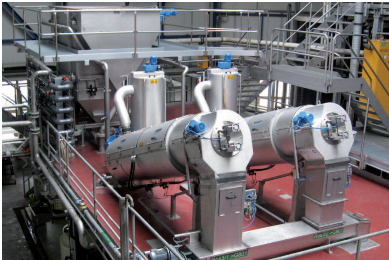
ROTAMAT® Schneckenpressen Ros 3 und HUBER Druckentspannungsflotation HDF 5 mit chemischer Stufe
