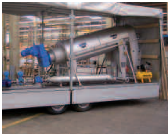
ROTAMAT® Schneckenpresse – Mobile Lösung für kleinere Kläranlagen
