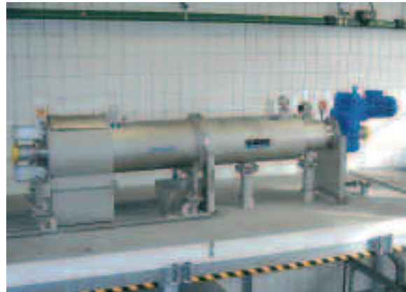
STRAINPRESS® – Kontinuierliche Grobstoffabscheidung unter Druck
