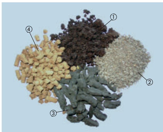
① Aerob stabilisierter Schlamm von einem Paddelmischer; ② zerkleinertes Gemisch aus Industrie- und Kommunalschlamm; ③ Extrudierter Faulschlamm; ④ Extrudierter Wasserwerkschlamm
