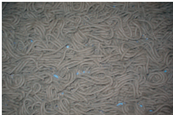
Die luftdurchlässige Schlammschicht wird langsam und schonend durch den Trockner bewegt; mechanische Beanspruchung und Stauberzeugung sind minimal
