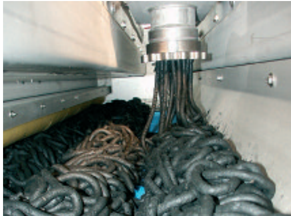
Die Schlammaufgabe über den Extruder ist entscheidend für die hervorragende Leistung unserer Bandtrockner
