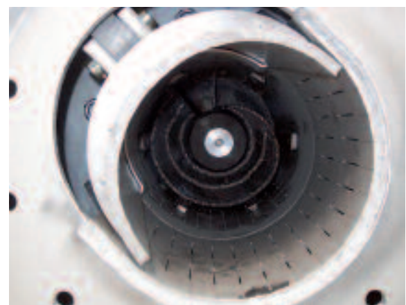
Das hydraulische Hochdruckpressteil garantiert hohe TR-Werte
