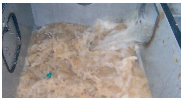
Das Pumpenlaufrad erzeugt hohe Turbulenzen im Waschtank
