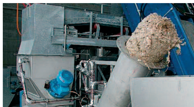
Gewaschenes und nahezu geruchsloses Siebgut aus einer HUBER Waschpresse WAP/SL, kompaktiert zu 50% TR
