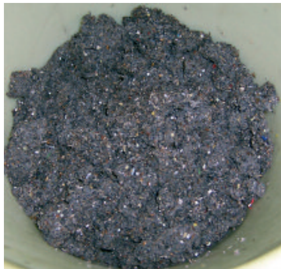
Abscheidung von sehr feinem Siebgut (insbesondere Haare) mittels des Pipestrainers nach vorgeschalteter Grobsiebung
