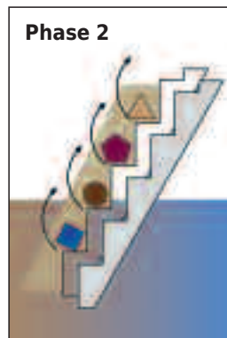
Phase 2 Anheben und Fördern des kompletten Rechengutteppiches durch Rotation des beweglichen Lamellenpakets
