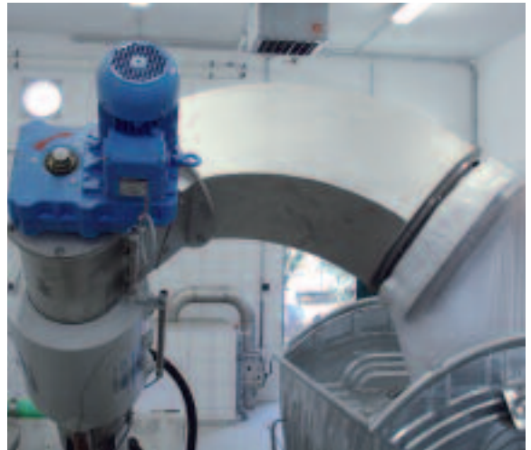
Individuelle Anpassung an bestehende Verhältnisse z.B. durch seitlichen Rechengutaustrag mit Abwurf direkt in einen Container
