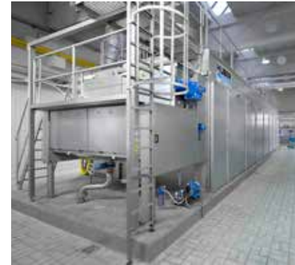
HUBER Bandrockner BT zur Klärschlamm-trocknung bis > 90 % TR.
