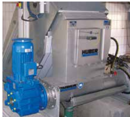
HUBER Waschpresse WAP® installiert nach einem HUBER Stufenrechen STEP SCREEN®.
