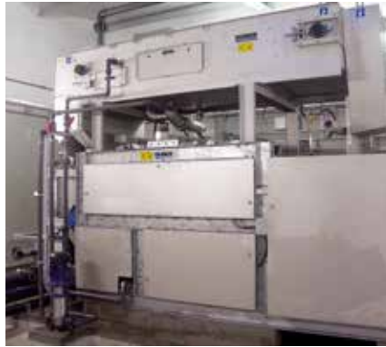
HUBER Bogenpresse B-PRESS: kombinierbar mit dem HUBER Bändeindicker DrainBelt für hohe Durchsätze.
