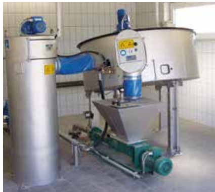
Einzigartige Eindicker: der HUBER Scheibeneindicker S-DISC.
