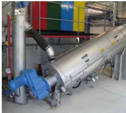
HUBER Schneckenpresse S-PRESS: spezifischer Leistungsbedarf < 0,01 kWh/kg TR .
