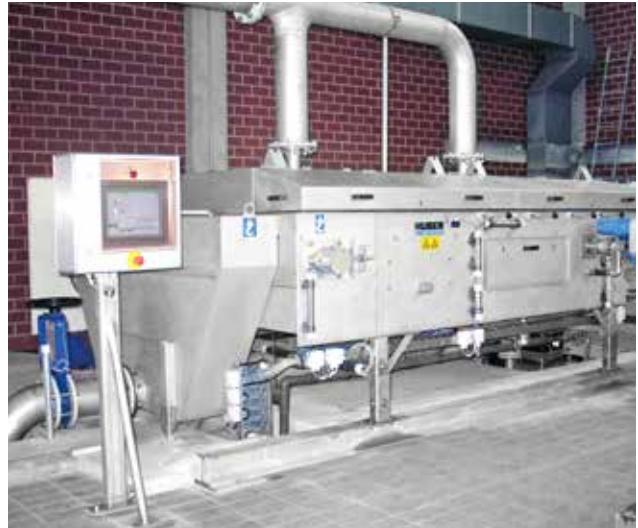
HUBER Bandeindicker DrainBelt für bis zu 100 m 3 /h Dünnschlamm.
