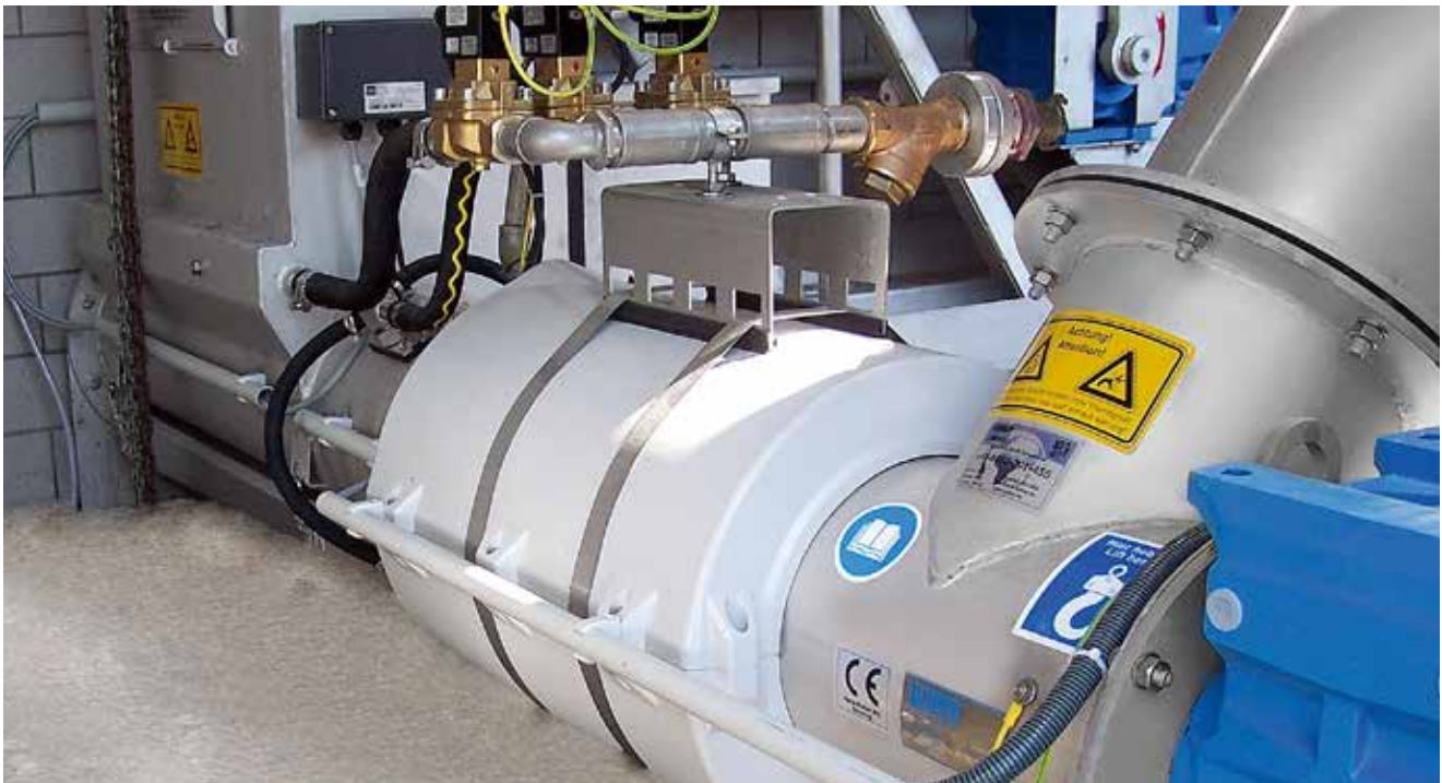
Kompakte Bauweise des HUBER Rechengutverdichter Ro7 – auch mit Rechengutauswaschung.
